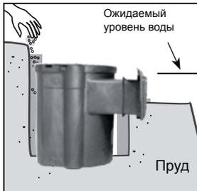
Теперь поставьте верхнюю крышу на Skimmerfilter и снова заполните область вокруг фильтра землей. Для этого Вам следует использовать влажный песок или мелкий гравий. Утрамбовывайте вручную каждые 5 или 7 см. Не утрамбовывайте слишком сильно. Немного увлажните засыпанную конструкцию для лучшей усадки.
