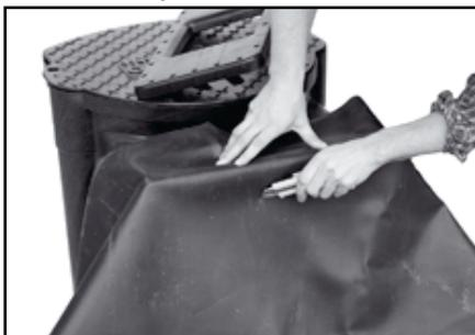
А) Сделайте надрезы шириной 7 см по центру прокладки на 2 см ниже вершины отверстия прибора.
