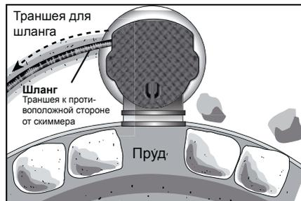
Вам необходимо выкопать траншею для шланга от насоса. Используйте сторону, которая ближе всего к водопаду или возврату воды. Удлините данную траншею таким образом, чтобы она соединилась с фильтром.
