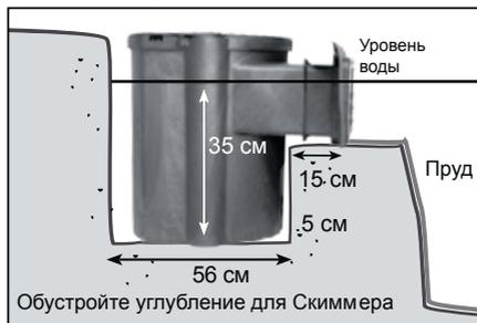
Сделайте углубление диаметром 56 см и глубиной 35 см ниже уровня воды. Расстояние до пруда должно быть около 15 см. Выкопайте переднюю часть углубления на 5 см ниже по сравнению с задней частью для того, чтобы компенсировать возможную усадку.
