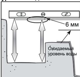
Установите должным образом Ваш прибор, а именно, с небольшим наклоном по направлению вперед. Передняя часть прибора должна быть на 6 мм ниже задней части. Еще раз проверьте соответствие уровня воды!
