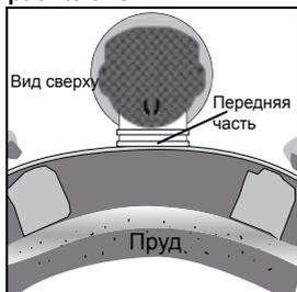
Убедитесь в том, что передняя часть Skimmerfilter расположена на одном уровне с кромкой прудовой плёнки. При необходимости Вам следует провести дополнительную регулировку.
