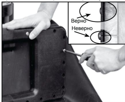
Используйте крестовую отвертку для установки винтов во всех четырех углах. Далее закрепите оставшиеся винты. Закручивайте верхние, нижние и боковые винты до тех пор, пока головки винтов не создадут устойчивую водонепроницаемую защиту. **Не перекручивайте! Не используйте электрический шуруповёрт.**
