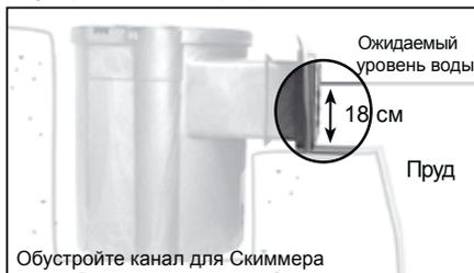
Выкопайте канал на 18 см ниже уровня воды ( смотри рис. А ) и шириной 38 см ( см. рис. В ) для того чтобы поместить там горловину скиммера для фильтрации ( Skimmerfilter 30 ). Утрамбуйте дно. Не копайте слишком глубоко, так как почва может распределиться неравномерно.
